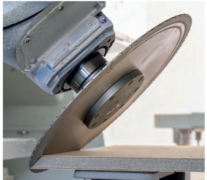
LEUCO nn-System sur CN : coupe d'onglets propre dans du verre expansé plaqué des deux côtés
