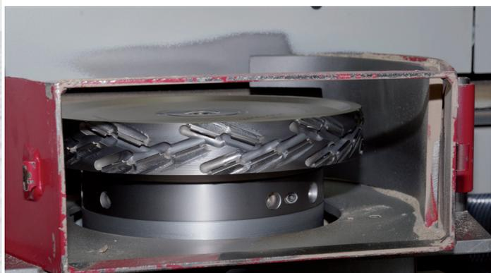
*Les dents au diamant d'angle d'axe de 70° sont clairement visible sur l'outil p-System.*
