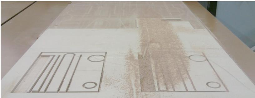
*Exemple dans du MDF : usinage avec AEROTECH (à gauche) par rapport à un usinage conventionnel (à droite)*
