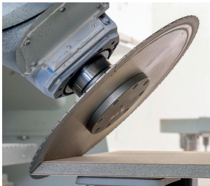
LEUCO nn-System sur CN : coupe d'onglets propre dans du verre expansé plaqué des deux côtés
