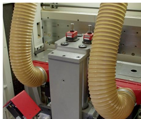
*Nobilia utilise deux fraises p-System dans la même machine, l'une pour les panneaux de 16 mm d'épaisseur et l'autre pour ceux de 19 mm.*
