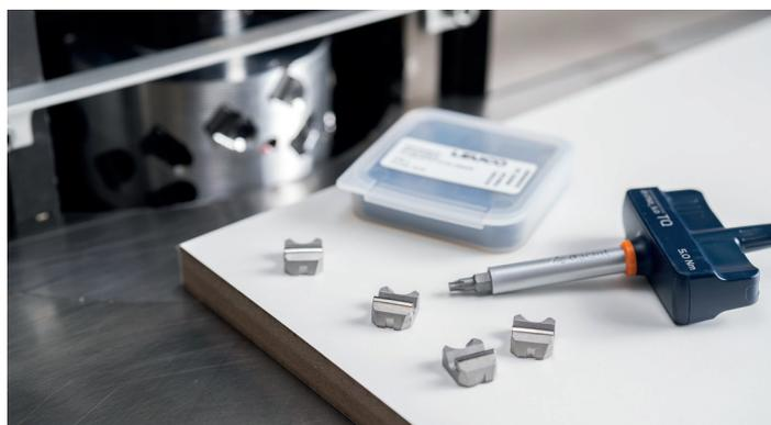
La fraise à dresser destinée à l'avance manuelle est disponible en D 125 et largeur de coupe de 43 mm avec 12 copeaux ou en 64 mm avec 18 copeaux. La particularité de la fraise à dresser SmartJoiner est que le diamètre reste constant même après le changement des copeaux et qu'il n'est pas nécessaire de procéder à un réglage de la machine. De même, les copeaux endommagés ou très usés peuvent être échangés entre eux, ce qui prolonge leur durée d'utilisation.
