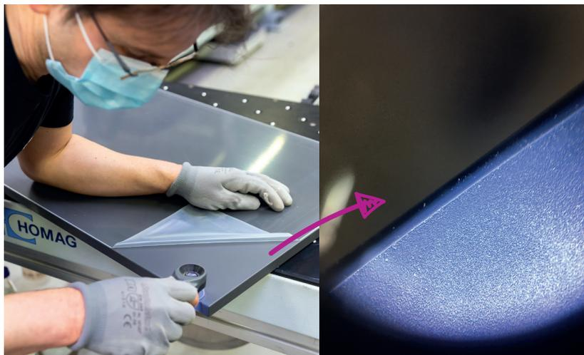
*Le joint doit être invisible. L'opérateur vérifie la qualité à la loupe, et peut observer une jonction impeccable entre le chant et la surface du panneau, sans microfissures.*
