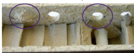
Comparatif d'usinage sur panneaux alvéolés
