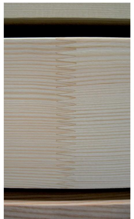
L'exécution de haute précision du corps confère à la fraise une planéité de 5µ grâce à laquelle on atteindra une qualité de l'aboutage excellente lors de la mise en œuvre en empilage de plusieurs fraises.
