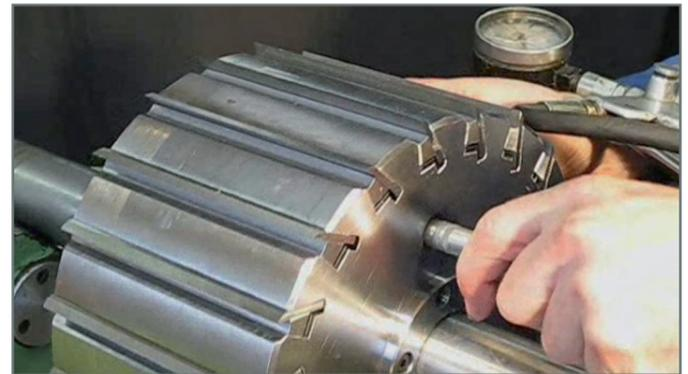
Changement rapide des copeaux grâce au système de serrage rapide
