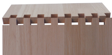
Fraisage à abouter sans éclat réalisé avec une fraise à queue à rainurer p-System de LEUCO
