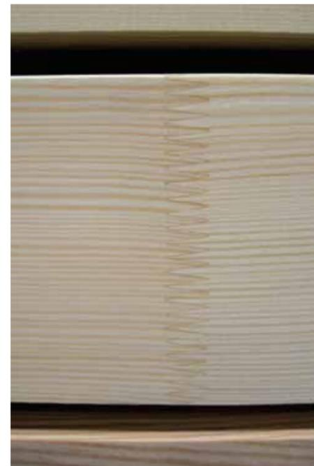
▲ La finition de haute précision du corps de base confère à la fraise une précision axiale de 5µ, permettant d'obtenir une excellente qualité d'aboutage lors de l'empilage de plusieurs fraises.
